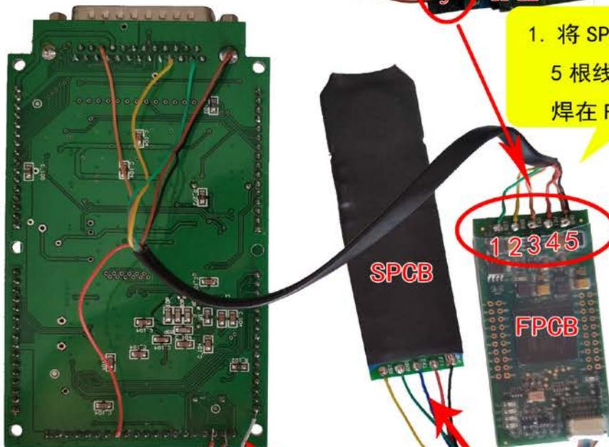
2. 将 FPCB 上的线按颜色正确的焊在 SPCB 和主板上
