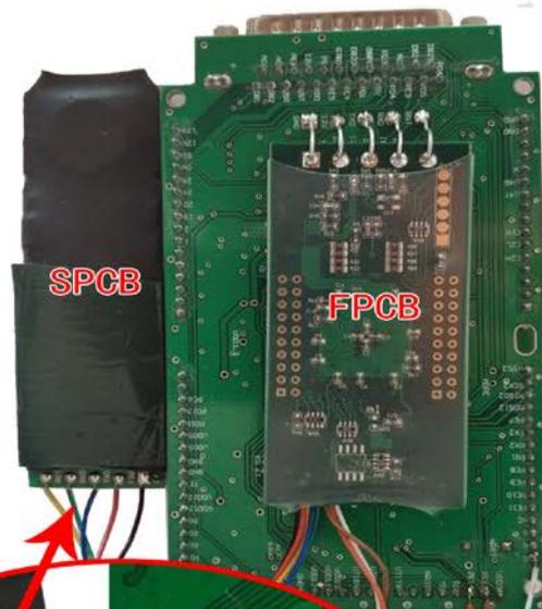
3. 将 FPCB 上的线按颜色正确的焊在 SPCB 和主板上。
